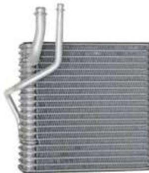
Figura 2. Evaporador de aire acondicionado automático. Fuente:
